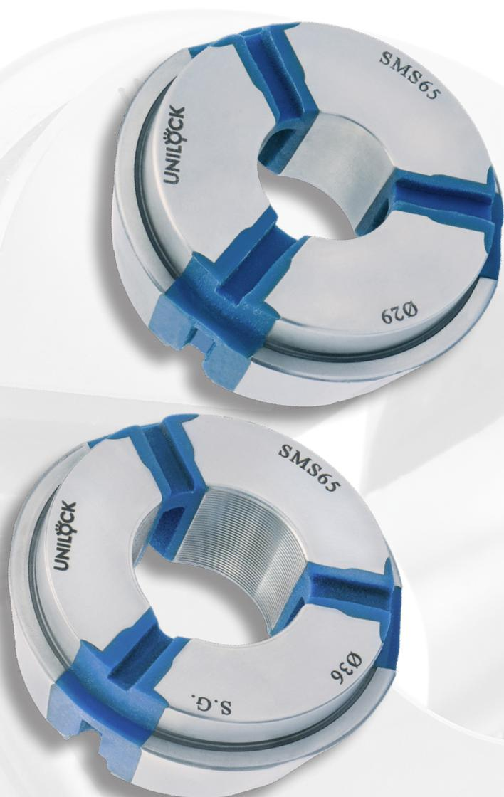
**Le pinze di serraggio - SMS**, sono composte da inserti metallici uniti da gomma vulcanizzata. Questo consente una perfetta chiusura radiale che blocca il pezzo su tutta la lunghezza del foro ed elimina l'intrusione di trucioli all'interno del mandrino.
