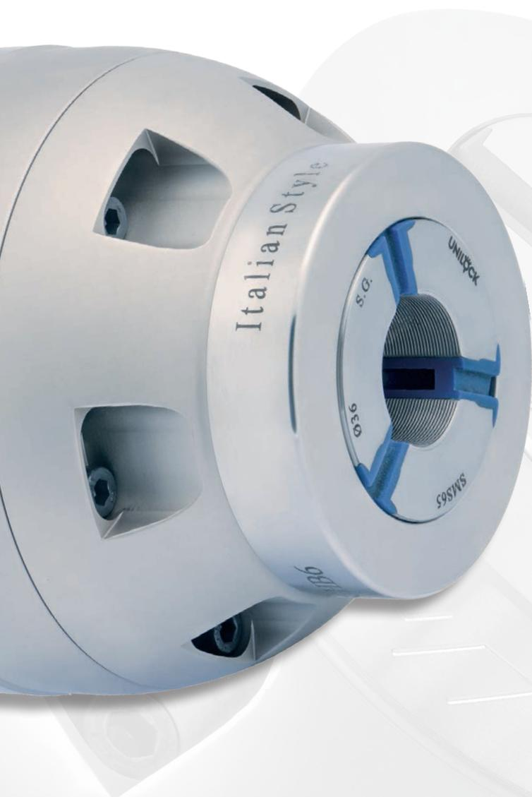
Con questo sistema la pinza rimane ferma, accoppiata alla ghiera del mandrino mentre il canotto conico posteriore avanza per il serraggio. Il cambio rapido della pinza avviene semplicemente svitando la ghiera anteriore.
