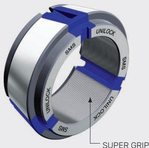
Le **PINZE SUPER GRIP** oltre a mantenere le caratteristiche di base, presentano all'interno una rugosità ottenuta meccanicamente **ad alto coefficiente di attrito**, che aumenta ulteriormente la forza di serraggio.
