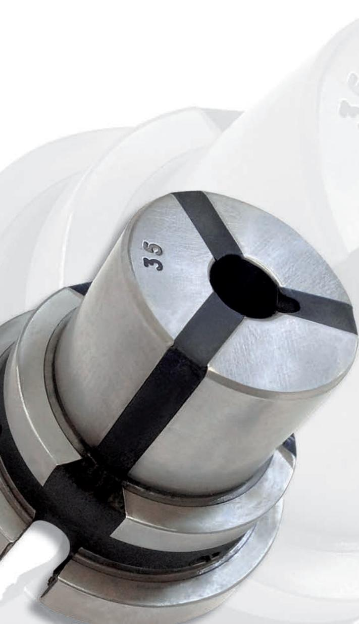
**Le pinze di serraggio - SME**, sono composte da inserti metallici temprati uniti da gomma vulcanizzata. Questo consente una perfetta chiusura radiale bloccando il pezzo su tutta la lunghezza del foro, ed elimina l'intrusione di trucioli all'interno della pinza.
