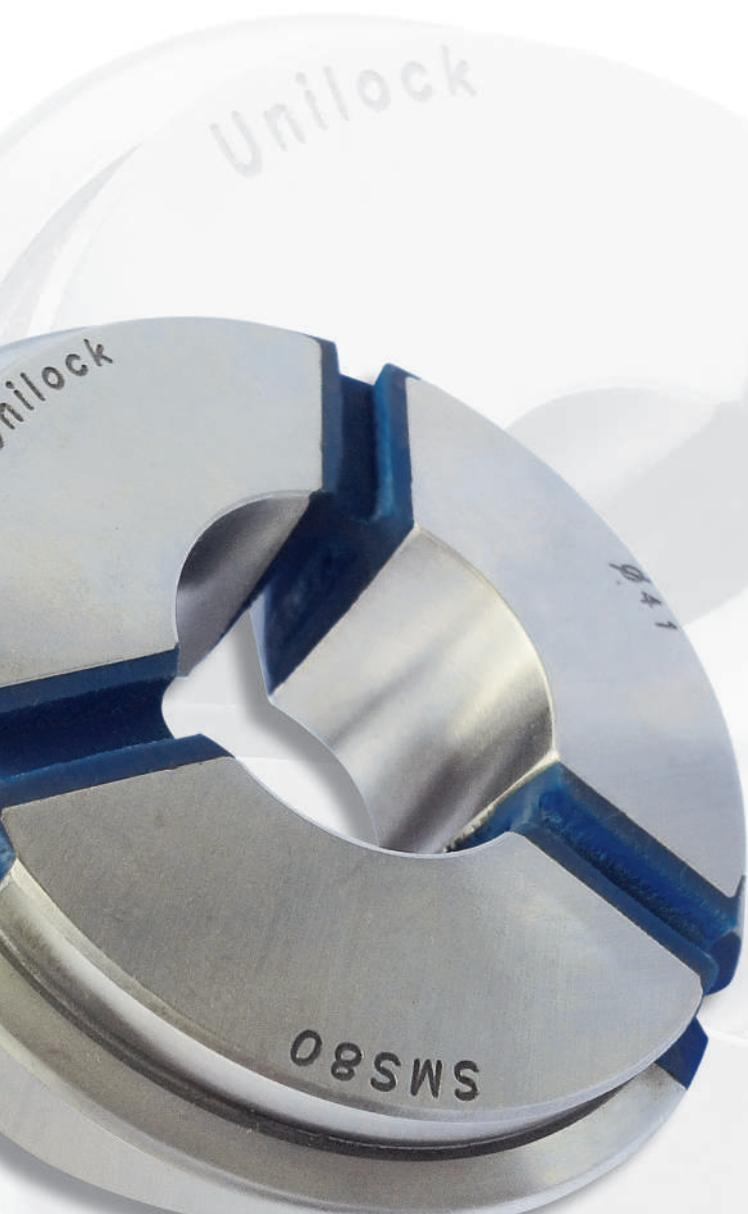
**Le pinze di serraggio - SMS**, sono composte da inserti metallici uniti da gomma vulcanizzata. Questo consente una perfetta chiusura radiale bloccando il pezzo su tutta la lunghezza del foro, ed elimina l'intrusione di trucioli all'interno del mandrino.
