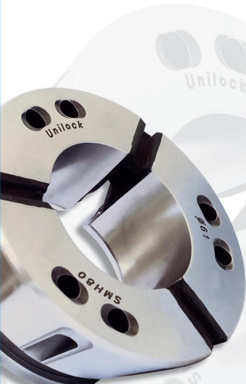
**Le pinze di serraggio - SMH**, sono composte da inserti metallici uniti da gomma vulcanizzata. Questo consente una perfetta chiusura radiale bloccando il pezzo su tutta la lunghezza del foro ed elimina l'intrusione di trucioli all'interno del mandrino. Applicate al mandrino principale del tornio, sono adatte a lavorazioni da barra. Inoltre la duttilità costruttiva del sistema permette facili soluzioni specifiche (barre trafilate, laminati, tubi).
